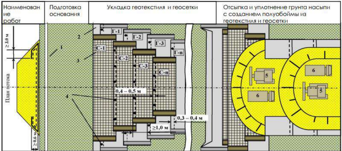
Рис. 3. Технологическая схема по армированию нижней части насыпи геосеткой в сочетании с разделяющей прослойкой из геотекстиля и устройством полуобоймы. 1 - слабое основание; 2 - геотекстиль; 3 - геосетка; 4 - анкера; 5 - бульдозер; 6 - самосвал.
