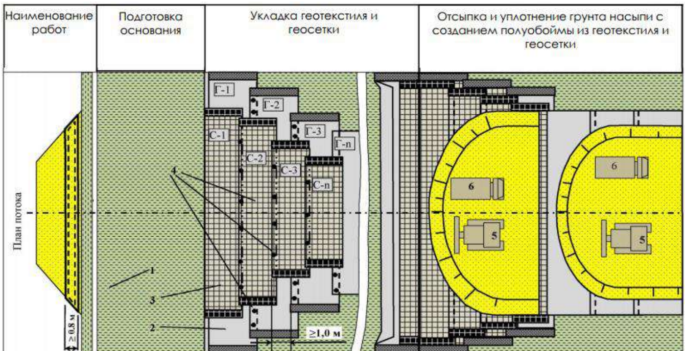
Рис. 4. Технологическая схема по армированию нижней части насыпи геосеткой в сочетании с разделяющей прослойкой из геотекстиля и устройством обоймы: 1 - слабое основание; 2 - геотекстиль; 3 - геосетка; 4 - анкера; 5 - бульдозер; 6 - самосвал. Гп, Сп - порядок раскатки рулонов, соответственно, геотекстиля и геосетки.
